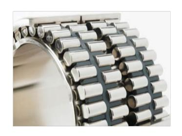
保持架是轴承重要的组成部分,滚动轴承在工作时,特别是载荷复杂且高速旋转时,保持架要承受很大的离心力、冲击和振动,保持架和滚动体之间存在较大的滑动摩擦,并产生大量的热量。力和热共同作用的结果会导致保持架故障,严重时会造成保持架烧伤和断裂。因此,要求保持架材料导热性好、耐磨性好、摩擦系数小,有较小的密度,一定的强度和韧性的配合、较好的弹性和刚度。与滚动体相近的膨胀系数.以及良好的加工工艺性能。另外,保持架还要受到化学介质,如润滑剂、润滑剂添加剂、有机溶剂和冷却剂等的作用。常用的保持架按材料种类划分主要有金属保持架和非金属保持架。另外还有复合材料保持架等。特殊用途的轴承保持架还应满足特殊工作条件的要求。如耐高温、耐腐蚀、自润滑(真空中使用)或无磁性等。常州UNITEC轴承报告。台州角接触轴承报告
